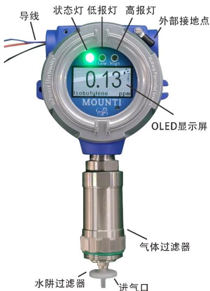
\*接地导线一端拧紧到检测器外壳上,另一端做可靠接地,接地导线应选用截面积不小于 4mm<sup>2</sup>的线缆,外部接地应保证接地电阻小于 4 欧姆。
